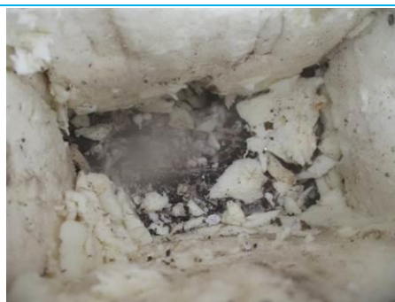
Matériaux : ZPSO-002 Prélèvement : P003; P004 Description : pare vapeur bitumineux Localisation : Toiture terrasse - sous isolant, sur dalle béton Résultat : Absence d'amiante
