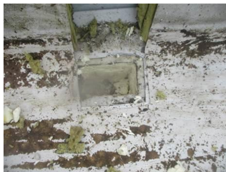
Matériaux : ZPSO-001 Prélèvement : P001; P002 Description : revêtement bitumineux bicouche + isolant polyuréthane Localisation : Toiture terrasse - sous membrane PVC Résultat : Absence d'amiante
