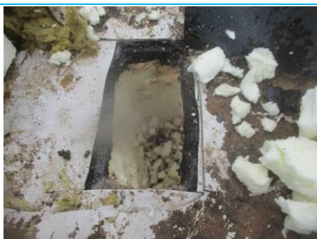
Matériaux : ZPSO-002 Prélèvement : P003; P004 Description : pare vapeur bitumineux Localisation : Toiture terrasse - sous isolant, sur dalle béton Résultat : Absence d'amiante
